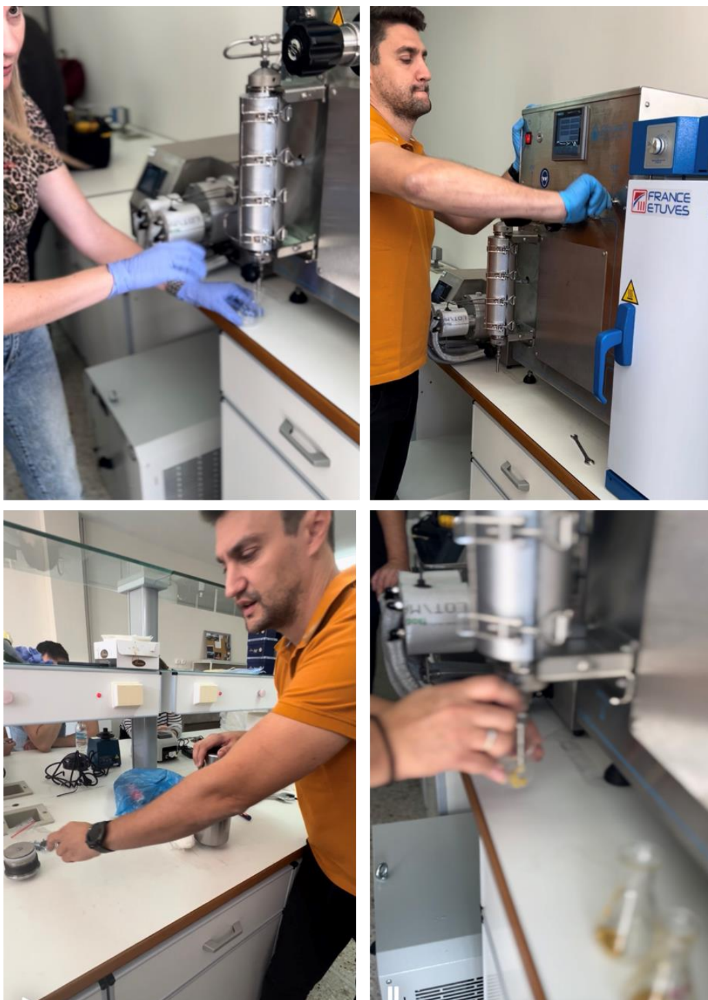
Εικόνα 2. Λειτουργία συστήματος υπερκρίσιμου CO 2 και εξαγωγή νερού από τα δείγματα προϊόντων
