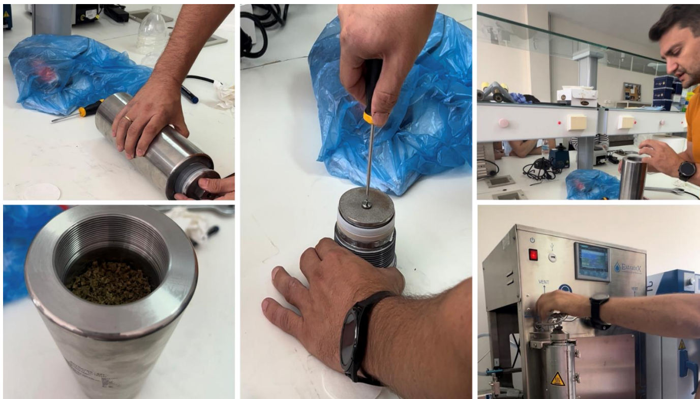
Εικόνα 1. Προετοιμασία δειγμάτων και τοποθέτηση στο basket του συστήματος
