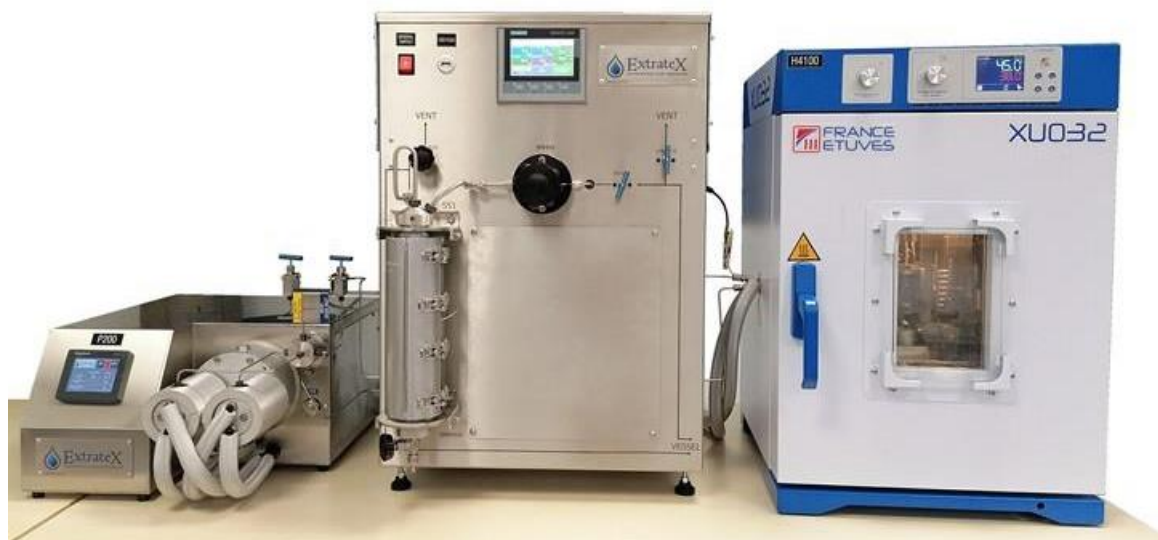
Διάταξη συσκευής υπερκρίσιμου ρευστού CO 2 στο εργαστήριο του ΙΓΒΦΠ-ΕΛΓΟ ΔΗΜΗΤΡΑ
