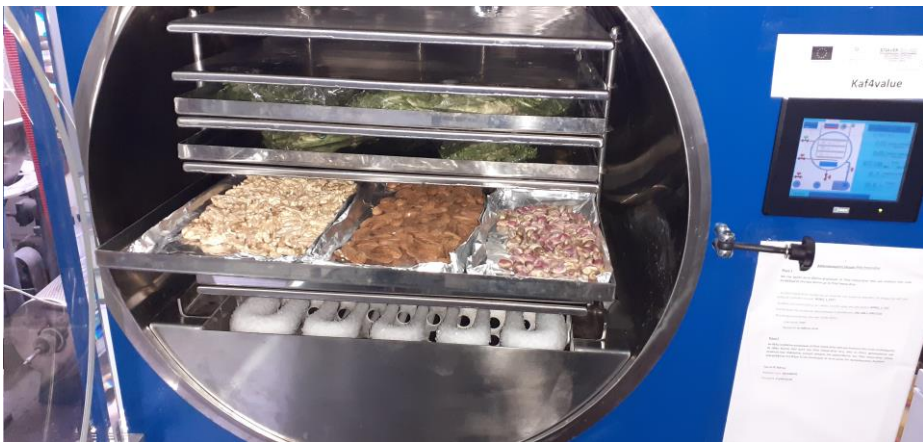
Πιλοτικής κλίμακας λυοφιλίωση
